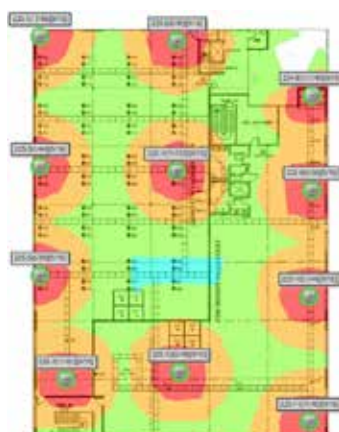
Figura 1. Asignación de canal con AirMatch
