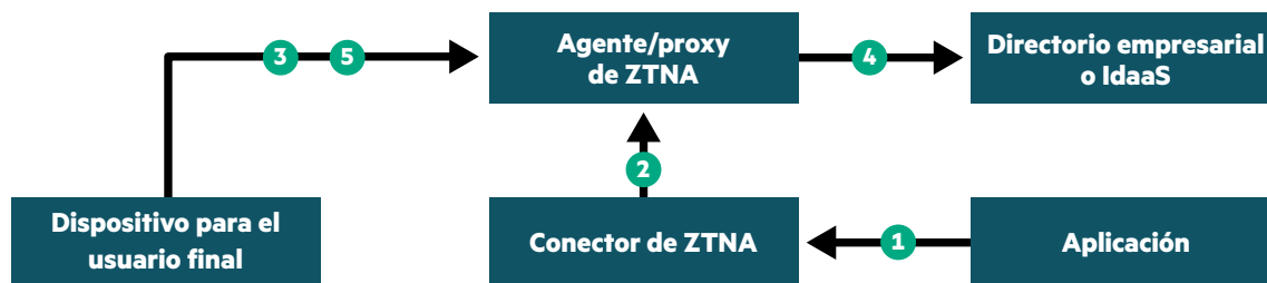
Figura 2. Cómo funciona una plataforma ZTNA iniciada por el servicio
