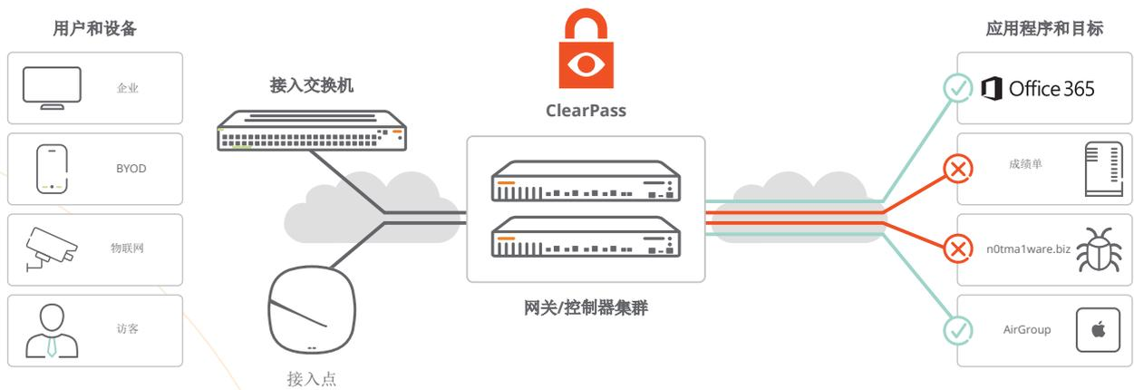
图 1: Aruba ClearPass 可自动分配通过动态网络隔离实现的，基于角色的访问控制策略
